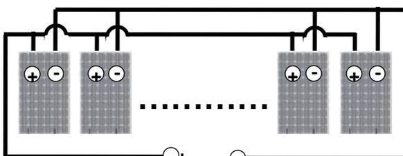
Parallelschaltung für höheren Strom
