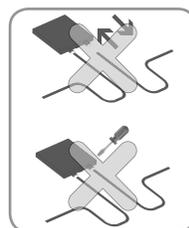
Das Kabel der Anschlussdose darf nicht geknickt werden. Wenn es unter Spannung steht, kann dadurch das Modul beschädigt werden. Der Biegeradius des Kabels muss mehr als das Vierfache des Kabeldurchmessers betragen.
