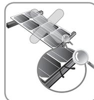
Das Kabel der Anschlussdose darf nicht neu verbunden oder repariert werden. Dies kann Funkenbildung oder Stromschlag zur Folge haben.
