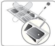
Die Beschichtung nicht zerkratzen Oberfläche des Rahmens. Kratzer können die Gesamtmenge verringern Solarleistung durch Korrosion von der Rahmen
