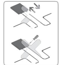
Das Kabel der Anschlussdose darf nicht geknickt werden. Wenn es unter Spannung steht, kann dadurch das Modul beschädigt werden. Der Biegeradius des Kabels muss mehr als das Vierfache des Kabeldurchmessers betragen.
