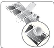
Setzen Sie die Anschlussdose des Moduls keinen Stößen aus und ziehen Sie nicht am Kabel. Entfernen Sie nicht die am Modul angebrachten Schilder. Die Nichtbeachtung kann zur Beschädigung des Produkts führen.
