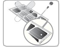
Leiten Sie nicht künstlich gebündelte Sonneneinstrahlung auf die Moduloberfläche. Die Nichtbeachtung kann zur Beschädigung oder zum Versagen des Produkts führen.
