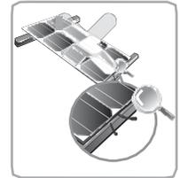
Das Kabel der Anschlussdose darf nicht neu verbunden oder repariert werden. Dies kann Funkenbildung oder Stromschlag zur Folge haben.
