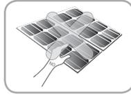
Belasten Sie das Solarmodul nicht mit schweren Gegenständen. Stellen Sie sich nicht auf das Modul und treten Sie nicht darauf. Lassen Sie das Modul nicht fallen. Die Nichtbeachtung kann zur Beschädigung oder zum Versagen des Produkts oder zu Verletzungen führen.
