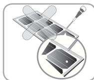
Berühren Sie nach der Installation nicht die Glasoberfläche oder den Rahmen des Solarmoduls. Dies kann zu Verletzungen oder zum Tod führen.
