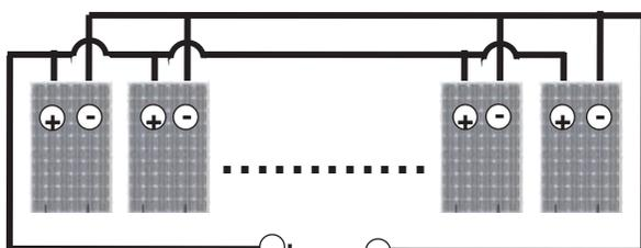
Parallelschaltung für höheren Strom
