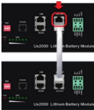
Abbildung 9: Nicht belegter „Link Port 0“ = Mastermodul
